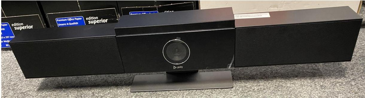
Die Soundbar wird in der Originalverpackung ausgeliehen. Entnehmen Sie die Soundbar und stellen Sie diese – wenn möglich – seitlich zu Ihrem Pult und etwas erhöht, damit die Kamera den Seminarraum gut übertragen kann.
